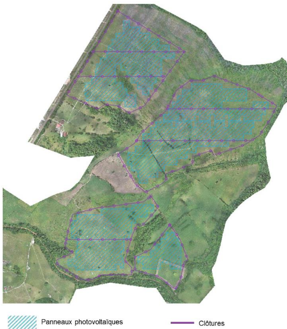
Figure 3 : Plan d'implantation prévisionnel des panneaux photovoltaïques
